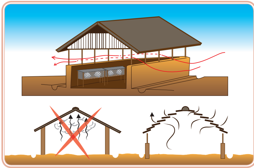
Figura 4.4: Circulação de ar dentro do galpão.
