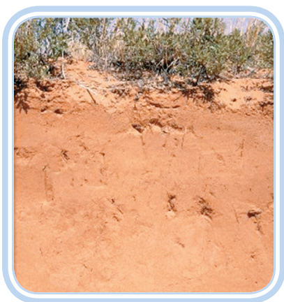
Figura 2.12: A foto é de um litossolo. Veja como o perfil não apresenta horizontes definidos.
