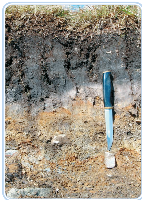
Figura 2.7: Observe como os horizontes são bem definidos em um argilossolo (veja a coloração diferenciada)
