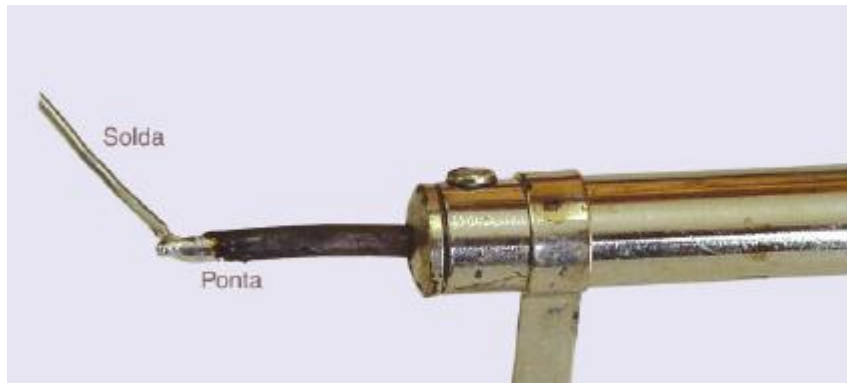
Figura 69: Estanhando a ponta. Fonte: www.mecatronicaatual.com.br/
