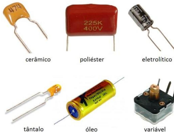
Figura 49 – Tipos de capacitores reais.
