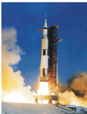
Um foguete, desses que vão para o espaço sideral, possui uma grande quantidade de energia química (no combustível) pronta a ser utilizada enquanto espera na rampa. Quando o combustível é queimado, esta energia é transformada em calor, uma forma de energia cinética. Os gases de escape produzidos impelem o foguetão para cima.
