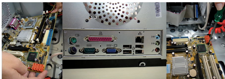
Figura 3.6: Fixação da placa-mãe no gabinete
