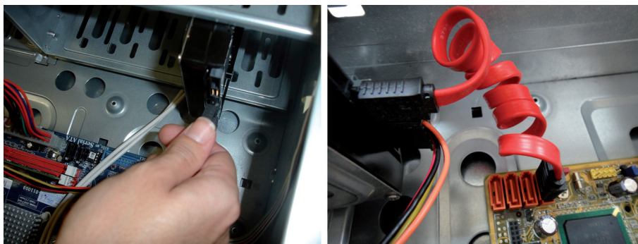
Figura 3.14: Conexão do disco rígido à placa-mãe via cabo SATA
