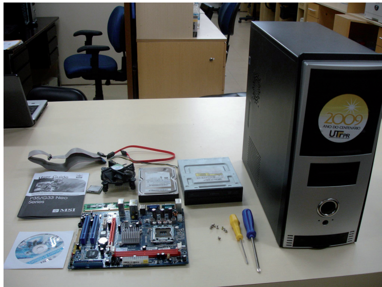
Figura 3.2: Componentes necessários para a montagem de um computador
