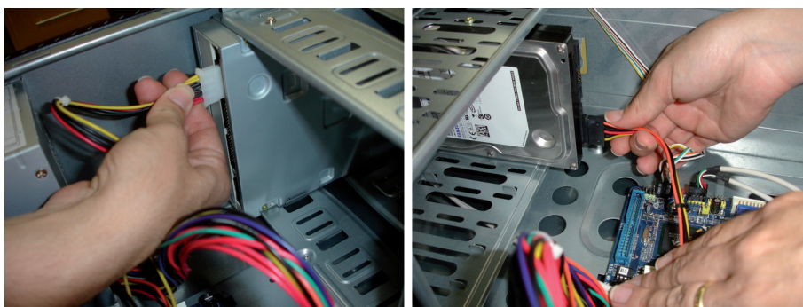
Figura 3.12: Conexão dos cabos de energia ao driver de CD/DVD e ao disco rígido
