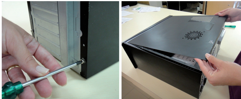
Figura 3.3: Desparafusando e retirando a tampa lateral do gabinete
