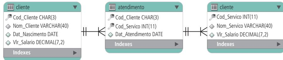
**Figura 2.5: Representação da entidade virtual Data utilizando MySQL WorkBench**
