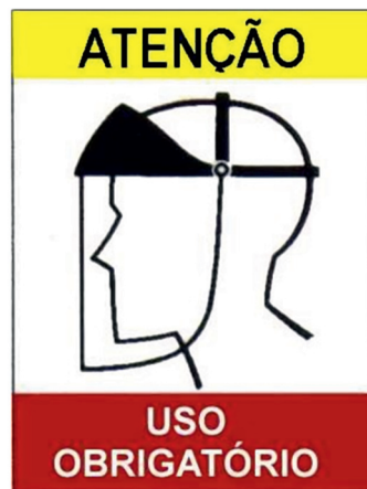
Figura 6.7: Esta placa indica a necessidade de atender ao uso obrigatório de EPI.
