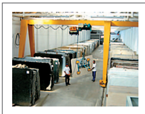
Figura 10 – Uso de ventosas no levantamento de chapas
