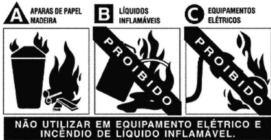
Figura 15.3: Você sabia que para cada classe de incêndio há um tipo específico de extintor? Pois é, por isso que, nos rótulos dos extintores, entre diversas informações, vêm as especificações da situação em que ele pode ser usado.
