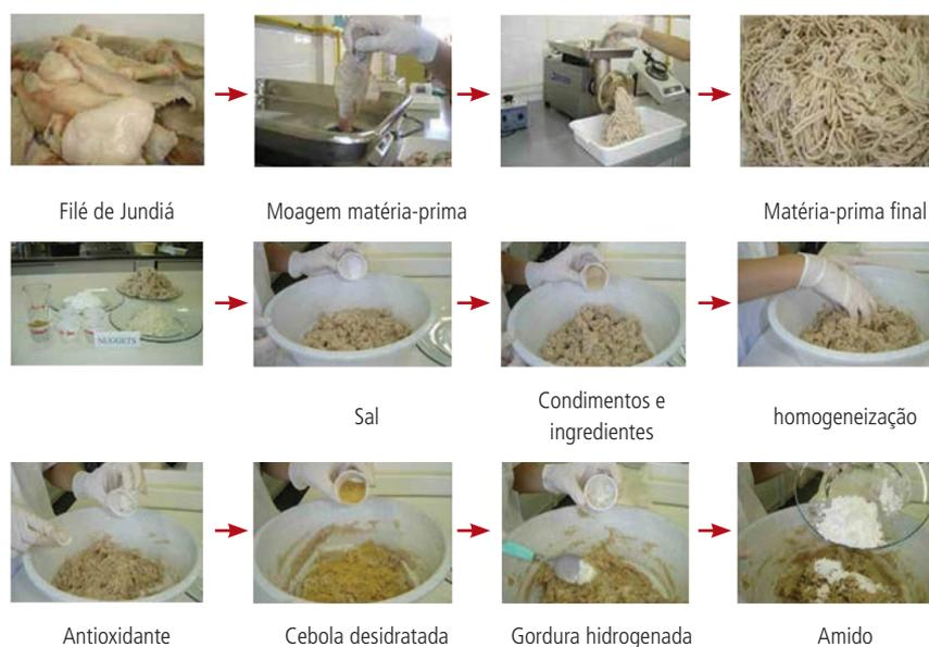
**Figura 12.1 - Fluxograma para obtenção de nuggets de Jundiá**
