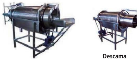
**Figura 5.2: Equipamento de descama do pescado**
