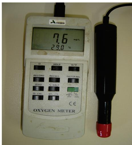
Figura 10.1 Detalhes de um Oxímetro para se obter os valores de Oxigênio Dissolvido.
