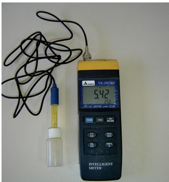
**Figura 8.3** Detalhes de um peagâmetro utilizado para obter os valores de pH.
