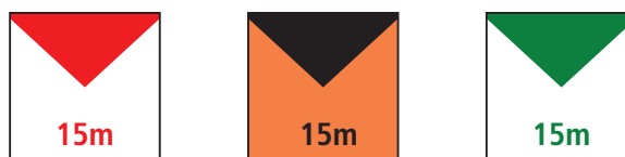
Figura 6.9: sinal de altura máxima de passagem
