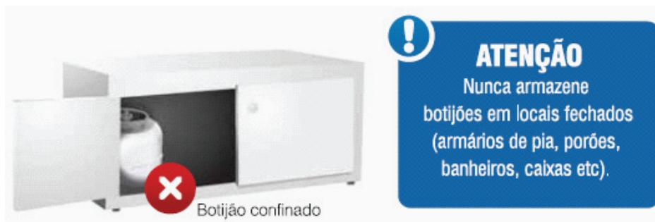
Figura 5 – Armazenamento inadequado GLP
