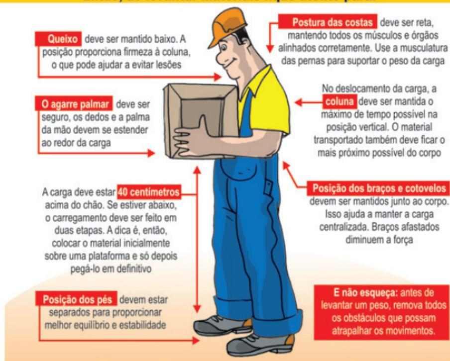
**Figura 6 – Levantamento e transporte manual de cargas**
