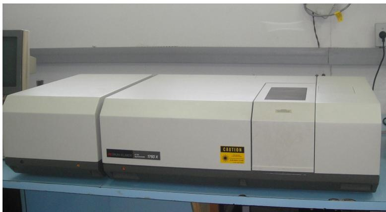
Figura 2.9 – Equipamento utilizado em análises de espectroscopia de infravermelho.
