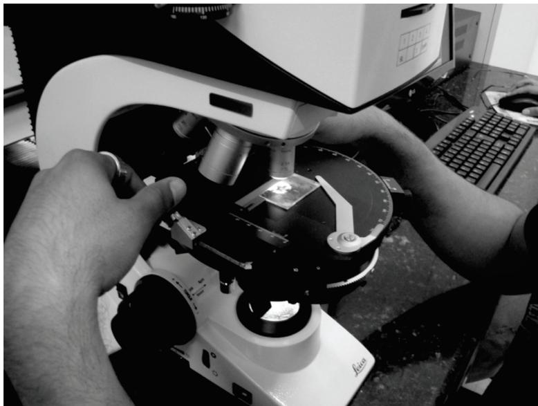
Figura 2.3 – Microscópio petrográfico utilizado para a identificação de minerais com base nas propriedades ópticas.
