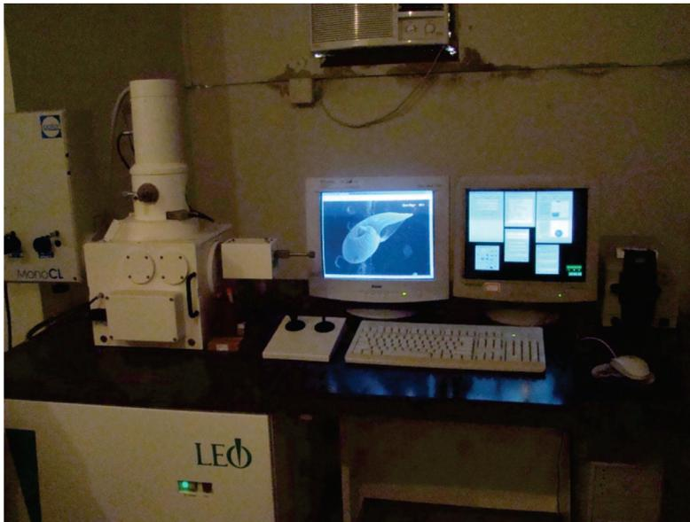
Figura 2.11 – Microscópio eletrônico de varredura utilizado para obtenção de imagens.
