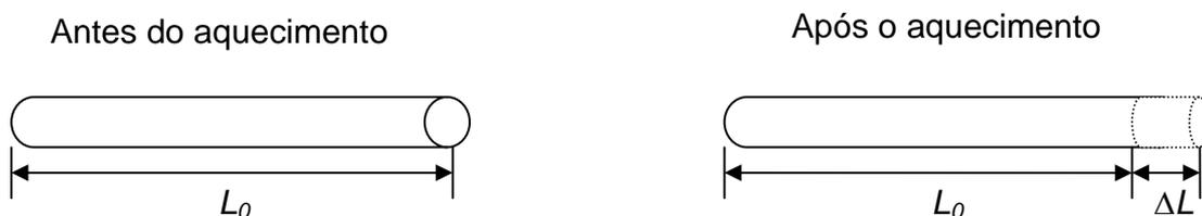
Do mesmo modo como vimos na dilatação dos líquidos, a variação relativa no comprimento da barra é proporcional à variação de temperatura ( $\Delta\theta$ ) e ao material de que é feita a barra. O material é relacionado através de uma constante ( $\alpha$ ) que é denominada *coeficiente de dilatação linear* do material. Temos, portanto:
