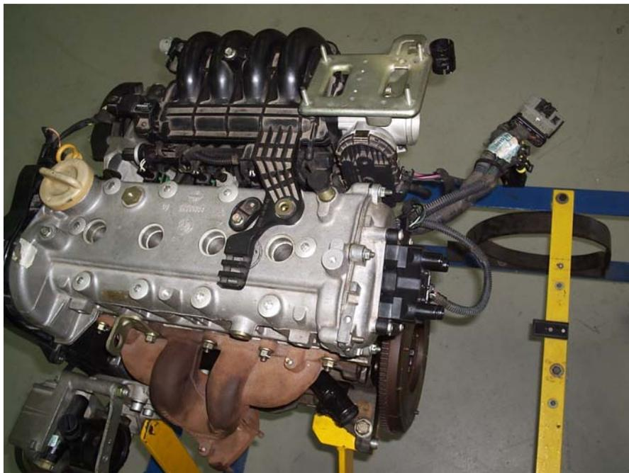
A mistura trabalhante é o vapor do combustível juntamente com oxigênio. A fonte quente é obtida através da combustão da mistura, ao ser atingida pela faísca proveniente da centelha na vela. A fonte fria é o meio ambiente, onde é dissipado o calor não utilizado pelo motor.
