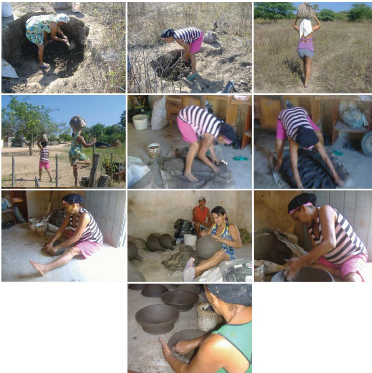
Obtenção da matéria-prima nos barreiros, transporte, preparação da massa argilosa e modelagem manual.
