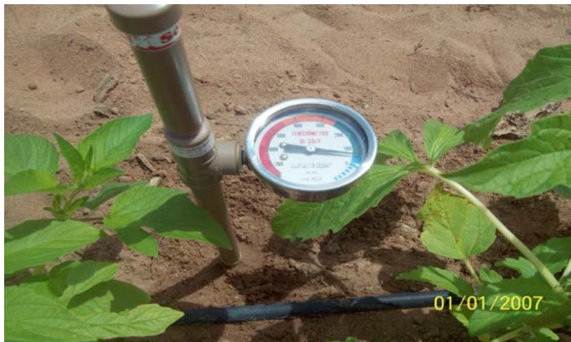
Figura 2 – Tensiômetro com escala graduada para monitorar a irrigação
