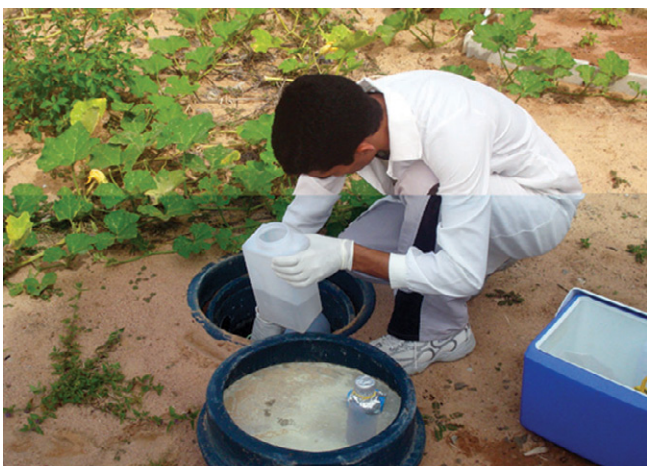
Figura 1: Coleta do esgoto bruto.
