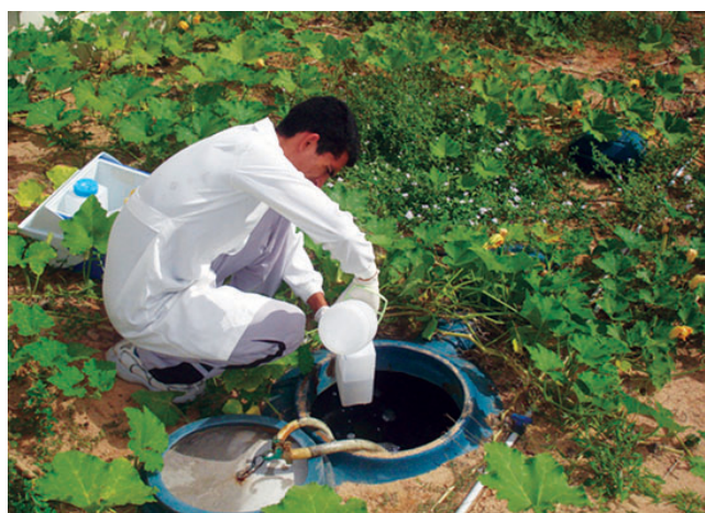
Figura 2: Coleta do esgoto tratado (água de reúso).
