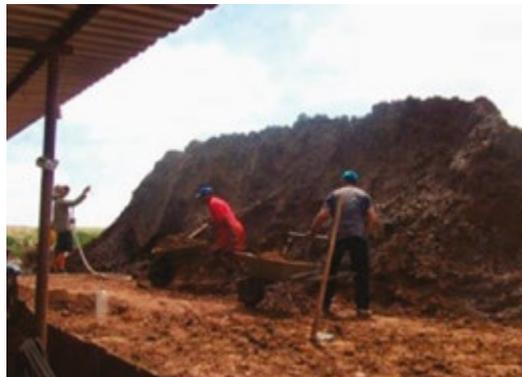
**Figura 7.9** – Alimentação manual em cerâmica da cidade de Ouro Branco no Seridó.
