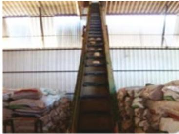
**Figura 10.21** – Esteira para transportar briquetes em bolacha para o depósito externo. Ao fundo, briquetes embalados em sacos de 20 kg.
