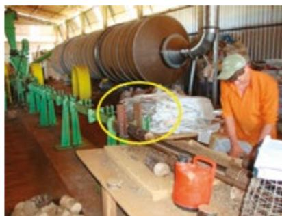
**Figura 10.5** – Briquetes saindo da briquetadeira e sendo embalados.
