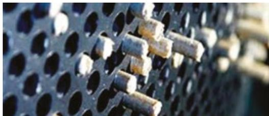
**Figura 10.4** – *Pellets* saindo da peletizadora.
