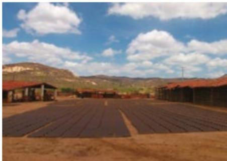
**Figura 7.12** – Secagem ao natural de telha em pátio aberto na região Seridó.
