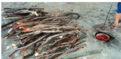
**Figura 7.25** – Alimentação do fogo de uma das câmaras de forno câmara com lenha. Baixo-Açu, RN.
