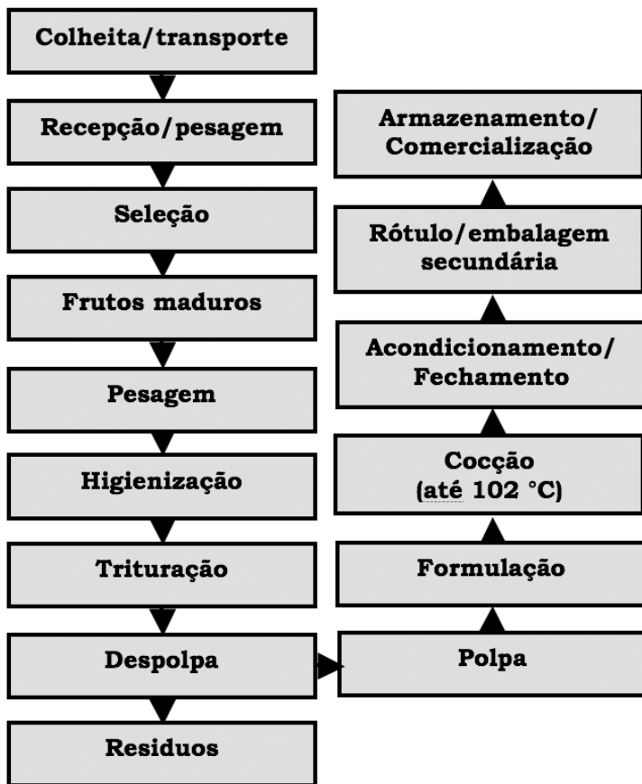
Figura 16 - Fluxograma de processamento de geleia diet e light de cajá.
