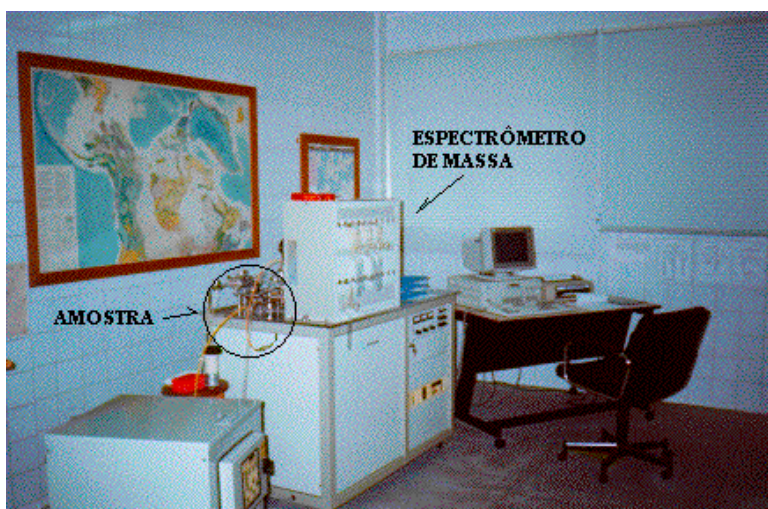
Figura 3.27- Equipamento utilizado para ensaios de espectrometria de massa com as conchas.
