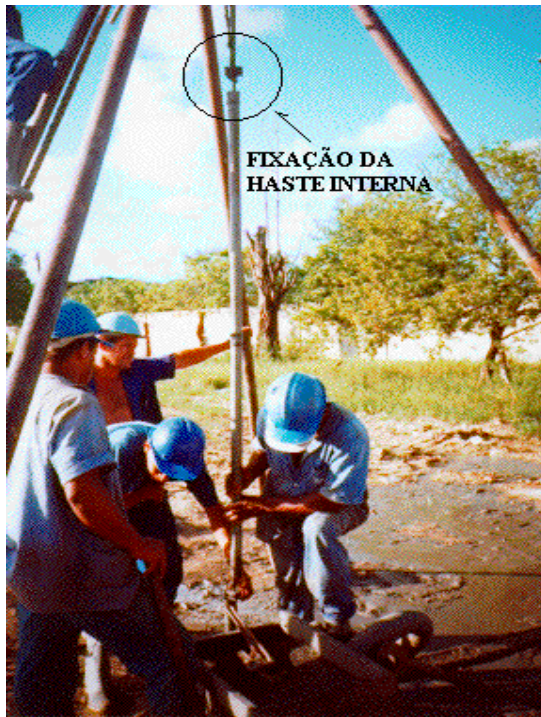
Figura 3.10- Procedimento para fixação da haste do pistão estacionário.
