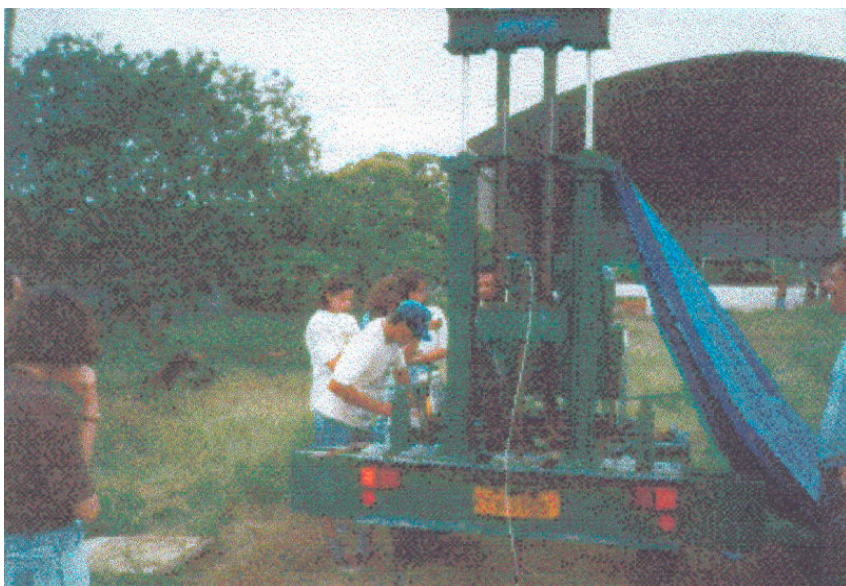
Figura 4.10- Realização do ensaio (aplicação de pressões).
