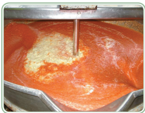
Figura 3.19: Concentração de molho de tomate em tacho com camisa de vapor.
