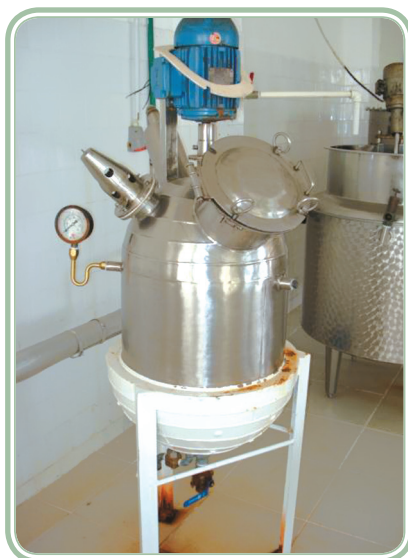
Figura 3.20: Tacho a vácuo com camisa de vapor.
