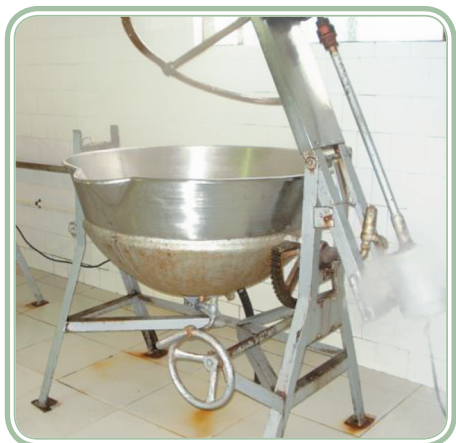
Figura 3.18: Tacho com camisa de vapor.
